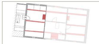
afb. 12 Historisch waardevolle elementen verdieping: moerbalk met natuurstenen console, houten plankenvloer, houten stijl en regelwerk gemene muur 10 - 12.
